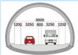
令和5年度の開通を目指す。指し国道161号北小松工区工事が進んでいます。6月16日に延長414m幅員9.5mが貫通。令和2年度追加補正5億円。令和3年度予算16億円の予算が投入されてトンネル
